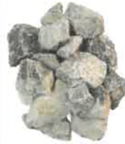
Comblement avec des graviers propres jusqu'à -1m du sol
